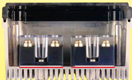
Ejemplo de instalación de relés de estado sólido en una carcasa de aluminio de Ultimheat (compuesto térmico en rojo).
